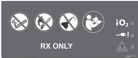
Advarselsmærkat på enhed og alarmdisplay.
